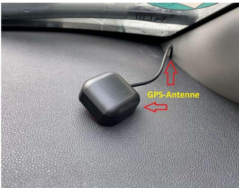
Das Kabel der GPS-Antenne wird im rechten Eck des Armaturenbrettes nach unten geführt. Die Arbeit ist ein wenig fummelig, es geht aber sogar ohne Hilfsmittel mit ein wenig Geduld und Geschick.
