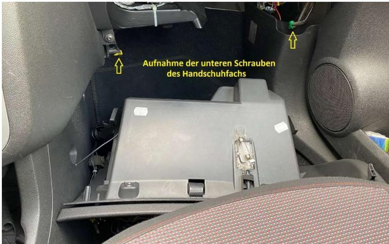
Das Handschuhfach muss demontiert werden. Hierzu sind 4 Schrauben (Torx 20) zu lösen. Die Aufnahme der unteren Schrauben sind hier gekennzeichnet.
