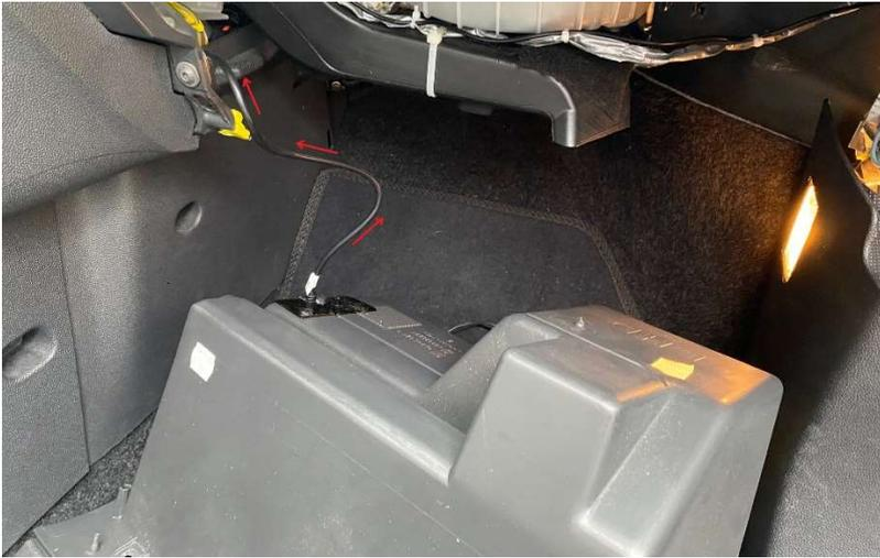
In das Handschuhfach muss von hinten ein Loch für die Durchführung des USB-Kabels gebohrt werden. Dann das Kabel von innen nach außen und zum Radioschacht führen. Evtl. mit Kabelbindern leicht fixieren.
